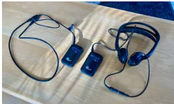
AURI-RX1-mottagare med halsslina och stereohörlurar.
